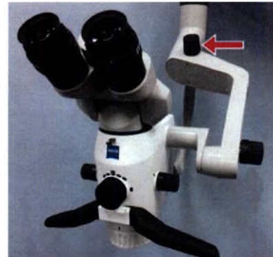
Тормоз на хомуте 120° для блокировки угла поворота
