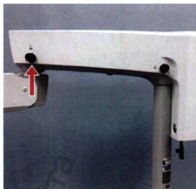
Тормоз оси 2 для фиксации балки подвеса
