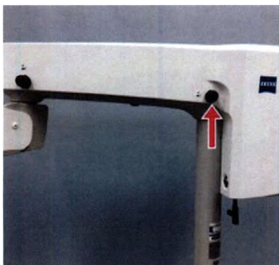
Тормоз оси 1 для фиксации держателя
